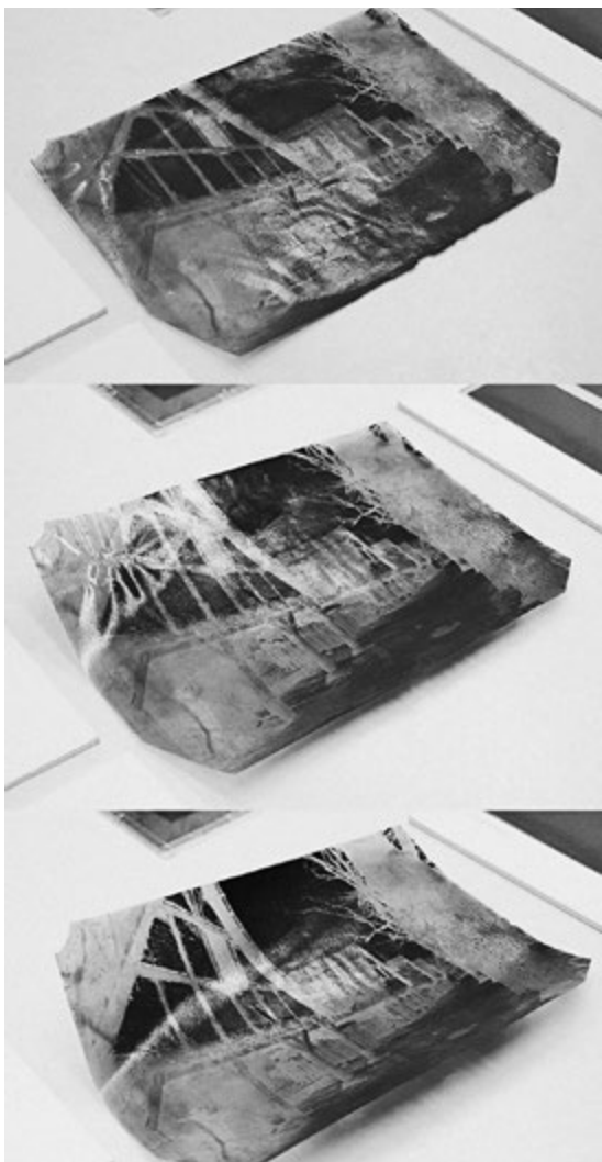
Fot. 2. Przykład dużej wrażliwości błony negatywu żelatynowego, odseparowanej od podłoża. Widoczna szybka deformacja w ciągu kilkunastu sekund od wyjęcia z opakowania w suchym pomieszczeniu (fot. T. Koziulec, zbiory Mogens S. Koch)
