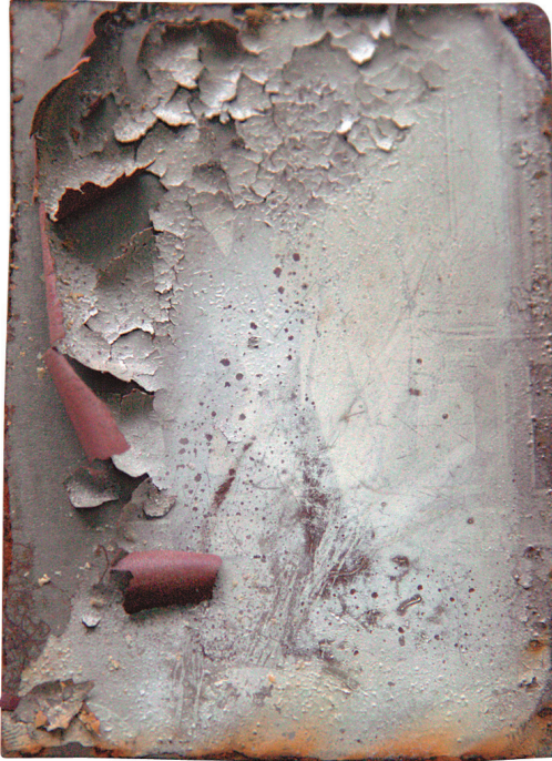
Fot. 12. Ferotypia po zakończonym procesie rozmrażania na powietrzu. Widoczna prawie całkowita utrata obrazu fotograficznego oraz postępująca delaminacja warstwy obrazu (fot. A. Seweryn)
