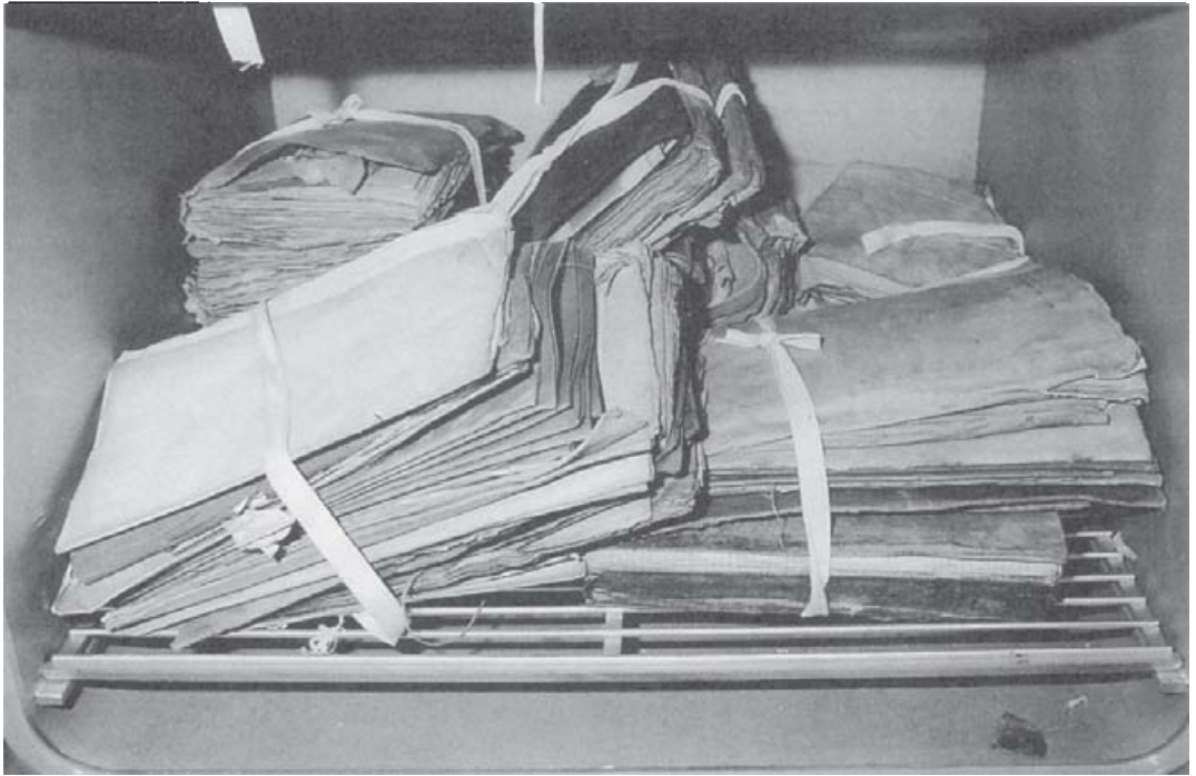
8. Obiekty luźno rozmieszczone na dolnej półce liofilizatora (fot. R. Stasiuk)
