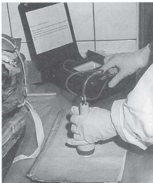
9. Kontrola wilgotności suszonych książek (fot. R. Stasiuk)
