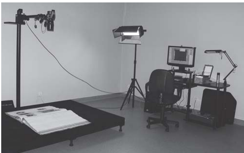
Stanowisko do skanowania materiałów bibliotecznych
